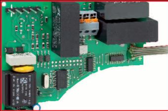
**Intelligent.** Die Elektronik erlaubt vielfältige Betriebsweisen wie Intervall, Nachlauf, Feuchte, Präsenz u.v.m. Die Platine trägt die Steckerstifte für die elektrische Verbindung und sitzt im strahlwasserdichten Gehäuse.
