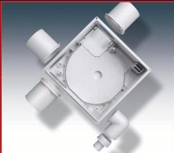
**Unbegrenzte Möglichkeiten.** ELS-GU ist das Universalgehäuse für die Einraum- oder für die Zweiraumlüftung mit Anschluss links, rechts oder unten sowie für WC-Anbindung über das Spülrohr. Der Ausblasstutzen kann oben, links, rechts oder rückseitig positioniert werden. Alles mit demselben Gehäuse!
