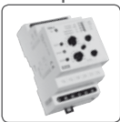
TER-4 Široký a přesný rozsah nastavení -40...+110 °C v 10-ti rozsazích v jednom přístroji, jemné dostavení teploty, 2 vstupy pro NTC senzor, 2 výstupy 16A přepínací, doplňující funkce (paměť, hysterese, indikace vadného senzoru) Napájení: AC 230 V nebo AC/DC 24 V (galv. odděleně)
