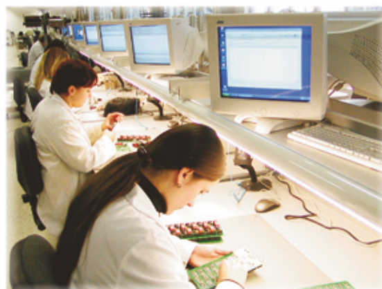
9) Po nezbytném testování ve fázi polotovaru na jehličkových testerech (obr. 9) se provádí sestavování a následná kompletace výrobku do krabičky. V průběhu celé fáze výroby je aktuální stav rozpracovanosti sledován pomocí čárových kódů (obr. 10).
