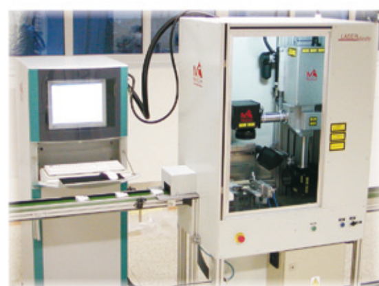
12) Nakonec jsou výrobky celoplošně potištěny laserovou technologií. Laser dokáže vypalovat z horní části (bočnice výrobku) a z boční části (přední panel a svorky). Potisk jednoho kusu trvá přibližně 30 s.
