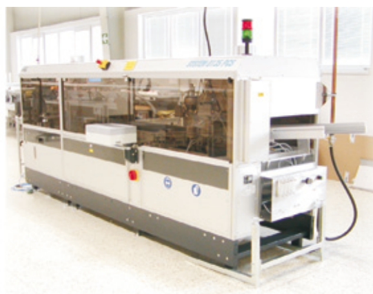
8) Po ručním dosazení klasických součástek následuje pájení na pájecí lince SEHO 8135-PCS, která již podporuje technologii pájení "lead free". Díky modulárnímu IR přehřevu dovoluje pájecí linka zpracovávat DPS i s teplotně citlivými součástkami na horní straně DPS. Pájecí linka je vybavena LW pájecí tryskou a Delta tryskou. Tyto umožňují kvalitní pájení součástek miniaturních rozměrů.
