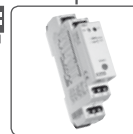
TER-7 Kontrola oteplení vinutí motoru v pásmu daném odporem zabudovaného PTC termistoru (1.8-3.3 kΩ), doplňující funkce (paměť, reset), výstupní kontakt 2x8A přep., napájení: AC/DC 24-240 V.
