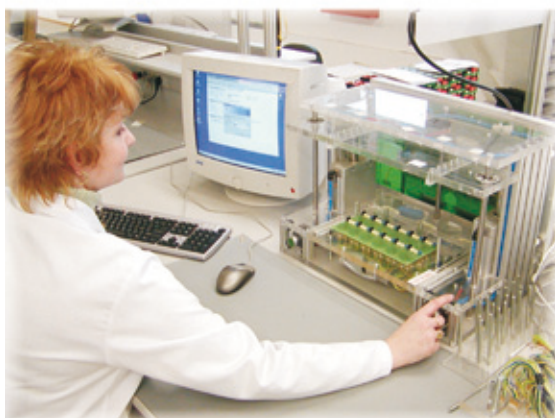
9) Po nezbytném testování ve fázi polotovaru na jehličkových testerech (obr. 9) se provádí sestavování a následná kompletace výrobku do krabičky. V průběhu celé fáze výroby je aktuální stav rozpracovanosti sledován pomocí čárových kódů (obr. 10).
